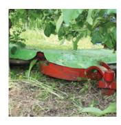
Регулировка натяжения боковой секции и низкие боковые ограждения позволяют работать в молодых садах и питомниках, не опасаясь повредить стволы.
