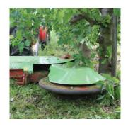
Стандартный гидравлический сдвиг на 80 см позволяет косить в садах с широкими насаждениями и широкой низкой кроной деревьев.
